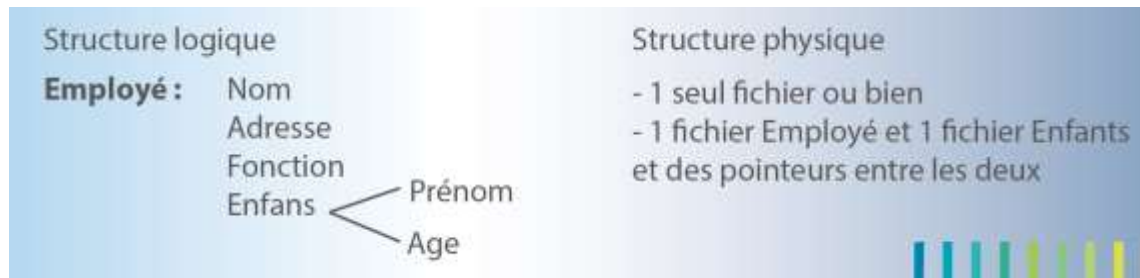
Figure 2 : Structure logique et principe d'indépendance
